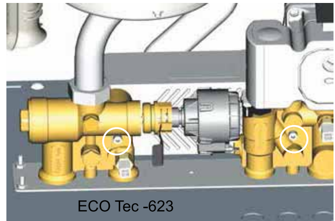
Figure 119 Dépose de l'échangeur thermique à plaques brasées en desserrant les deux (2) vis.
