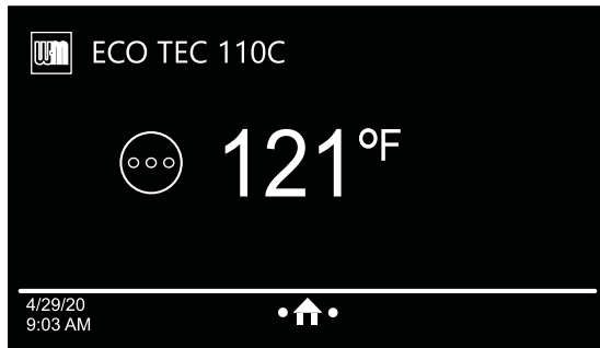
Figure 80 Accès aux menus du module de commande ECO – accéder aux menus Entrepreneur
